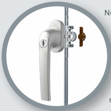
Nur ein abgeschlossener Griff trägt wirkungsvoll zum Sicherheitskonzept von HOFFMANN bei. Im Inneren des Fensterprofils ist das Griffgetriebe mit einem Anbohrschutz versehen, welches ein Aufbohren von außen unmöglich macht.
